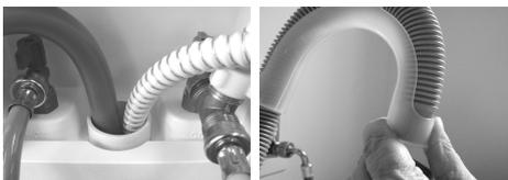
1. Se il tubo flessibile di CatGenie e il tubo di scarico della lavatrice non entrano facilmente nello scarico, rimuova entrambi i tubi flessibili. Metta dentro per primo il tubo di CatGenie, poi inserisca il tubo di scarico della lavatrice. 2. Se il tubo flessibile della lavatrice ha una guida, tenga insieme il tubo flessibile della lavatrice e la sua guida e li inserisca nello scarico.
