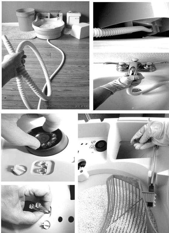
**A. Rimuovere la copertura della pompa.** Estrarre l'unità di elaborazione su e dalla sua sede. Mettere verticalmente su un asciugamano contro la parete. Ora srotoli il tubo dello scarico da sotto la base. Sollevare un lato della base non più di 5 cm. Fate uscire anteriormente il tubo flessibile dalla base secondo le indicazioni della foto.
